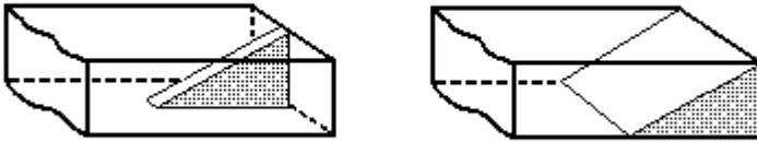
Esempi di carichi dissipativi che riempiono la parte terminale di una guida a sezione rettangolare.
